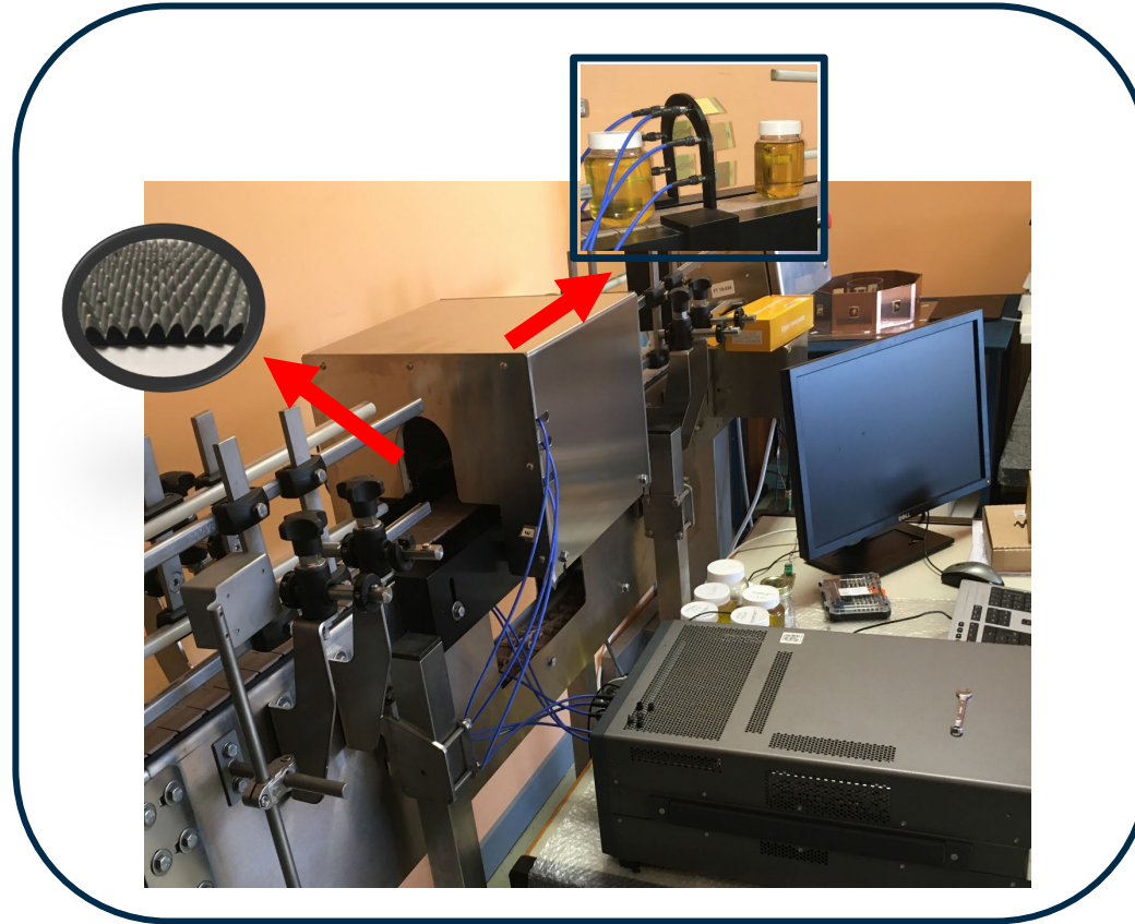
Acquisizione dati in 11 punti in frequenza [9-11 GHz] Prodotto in movimento (multivista)
